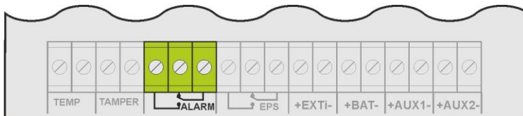
Rys. 7. Wyjście techniczne ALARM.
