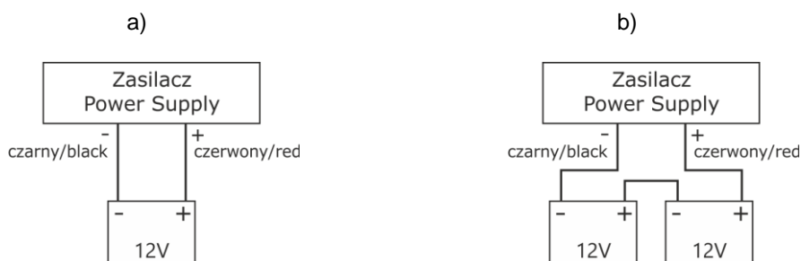
Rys. 5. Podłączenie akumulatorów w zależności od wersji zasilacza: a) zasilacze w wersji 12V, b) zasilacze w wersji 24V
