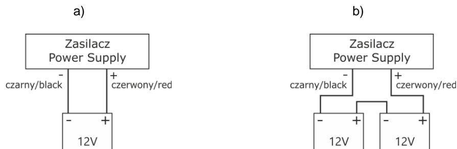
Rys. 4. Podłączenie akumulatorów w zależności od wersji zasilacza: a) zasilacze w wersji 12V, b) zasilacze w wersji 24V
