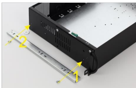
Upevnite posúvače dvoma skrutkami k skrinke ARAD (nezabudnite na podložku pod druhým skrutkom)
