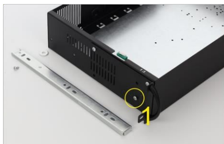
Odstráňte prvý skrutku M4 z krytu ARAD
