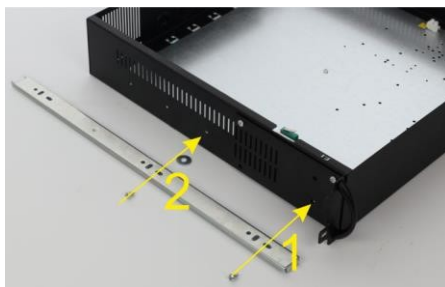
Pripevnite jazdce dvoma skrutkami k Kryt ARAD (nezabudnite na podložku pod druhou skrutkou)
