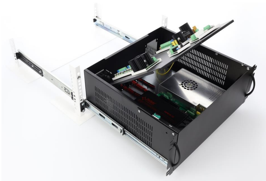
zasunutie skrine s posuvníkmi do koľajníc nainštalovaných v 19" skrini RACK
