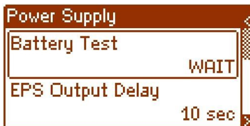
Obr. 28. Dočasné zablokovanie testu batérie.
