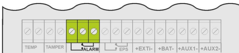
Obr. 8. Technický výstup ALARM.
