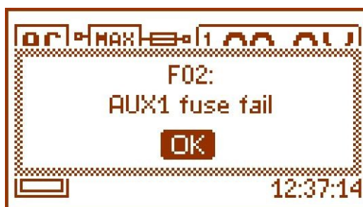
Obr. 18. Správa indikujúca prepálenie poistky na výstupe AUX1.
