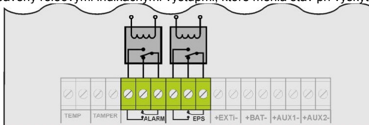
Obr. 5. Elektrická schéma reléových výstupov.
