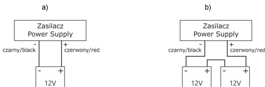
Obr. 5. Pripojenie batérií v závislosti od napät'ovej verzie napájacieho zdroja: a) napájacie zdroje verzie 12 V, b) napájacie zdroje verzie 24 V
