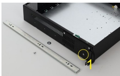
Entfernen Sie die erste M4-Schraube vom ARAD-Gehäuse
