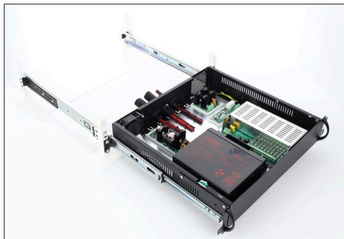
Gehäuse mit Schieber in die im 19"-RACK-Schrank installierten Schienen schieben
