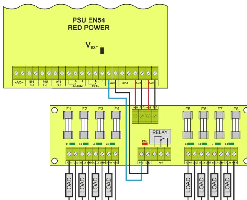
Beispielhafte Anschlussweise an die Sicherungsleiste EN54-LB8.
