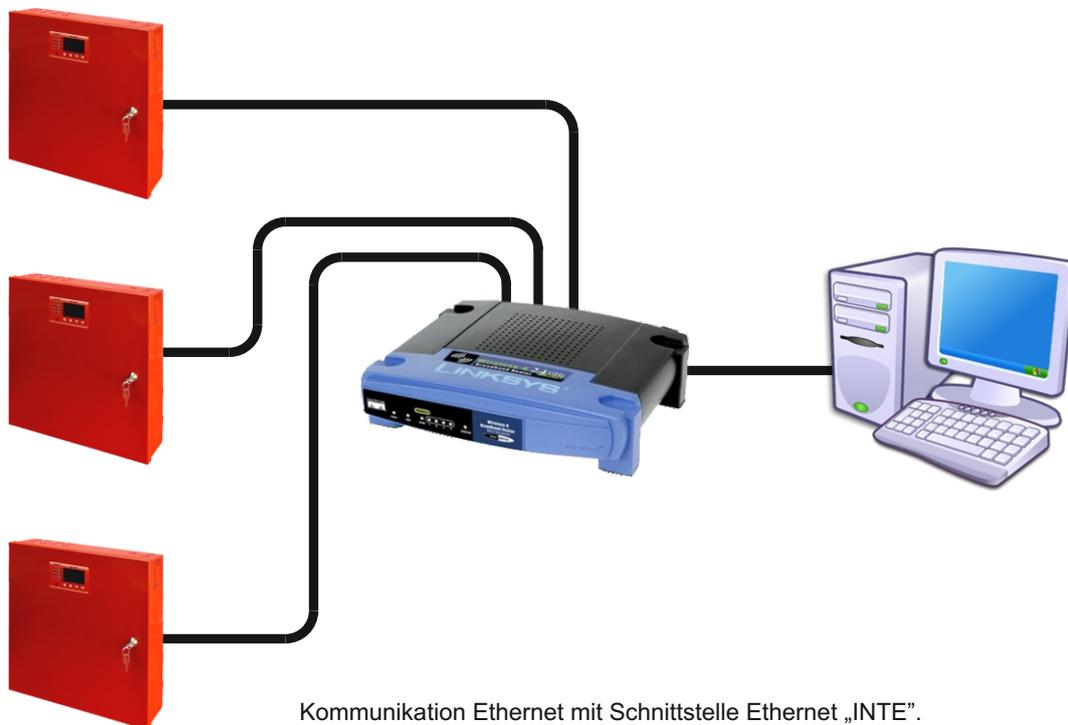
Die Schnittstelle RS485-ETHERNET „INTRE“ ist eine Anlage zur Umsetzung der Signale zwischen dem Bus RS485 und dem Ethernet-Netz. Zur korrekten Funktionierung bedarf die Anlage der Fremdversorgung 10+30V DC z.B. aus dem Netzteil EN54. Die physikalische Verbindung der Schnittstelle erfolgt mit Erhaltung der galvanischen Separation. Die Anlage wurde im luftdichten Gehäuse montiert, das gegen die ungünstigen Umwelteinflüsse schützt.
