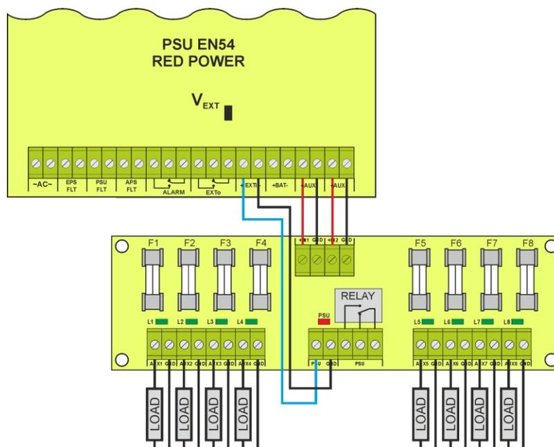
Beispielhafte Anschlussweise an die Sicherungsleiste EN54-LB8.
