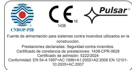
**"Este producto es adecuado para los sistemas diseñados de conformidad con las normas EN 54-4 y EN 12101-10"**
