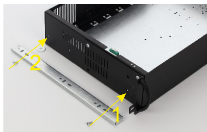
Rögzítse a csúszkákat két csavarral az ARAD házhoz (ne felejtse el a második csavar alatti távtartó alátétet).
