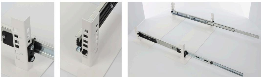
Rimuovere il cursore e fissarlo all'involucro ARAD (vite M4+ rondella). L'involucro deve essere fissato alla parte anteriore delle guide RACK con quattro viti M6.
