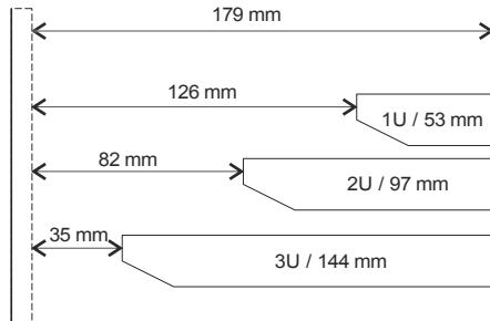
Distanze all'interno dell'involucro dopo il montaggio dei profili del rack da 19', distanza di 179 mm: porta anteriore incernierata - fondo dell'involucro
