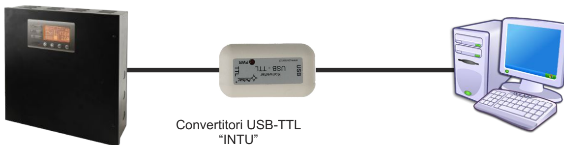
Comunicazione USB-TTL utilizzando l'interfaccia USB-TTL „INTU”.
