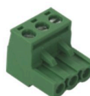
1 morsettiera a vite innestabile a 3 poli (passo 5,08 mm)
