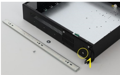
Odkręć pierwszą śrubę M4 z obudowy ARAD
