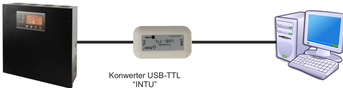
Komunikacja USB-TTL z wykorzystaniem interfejsu USB-TTL „INTU”.
