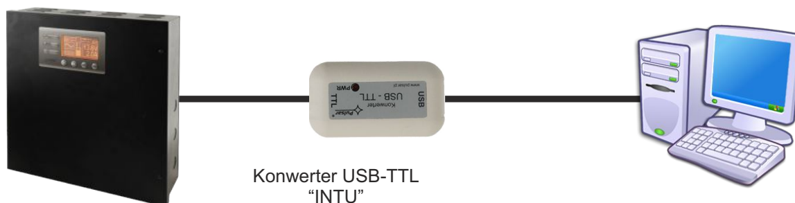
Komunikacja USB-TTL z wykorzystaniem interfejsu USB-TTL „INTU”.
